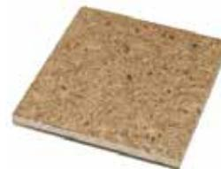
**Madera, tableros de fibra:** formados a base de madera desfibrada, sometidos a alta presión y temperatura sin el uso de cola o aglutinante.
